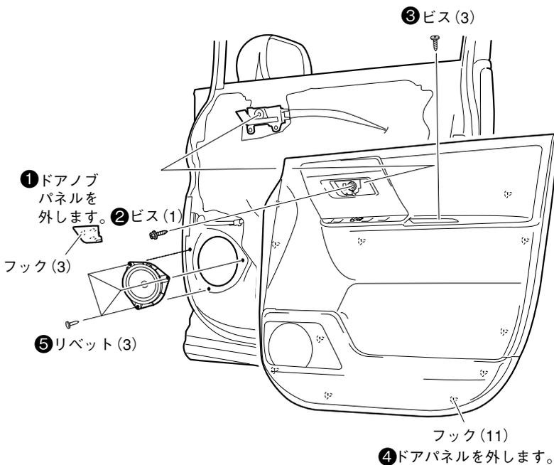
●スピーカーはリベット止めにしているため5mmドリルでリベットを外します。但しリベットを外した場合、リベットの再利用はできません。
